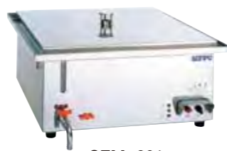
SEM-201 本体寸法 590×590×270 (mm) 電源 3相200V 4.5kw/h 蒸気発生量 7.2kg/h
